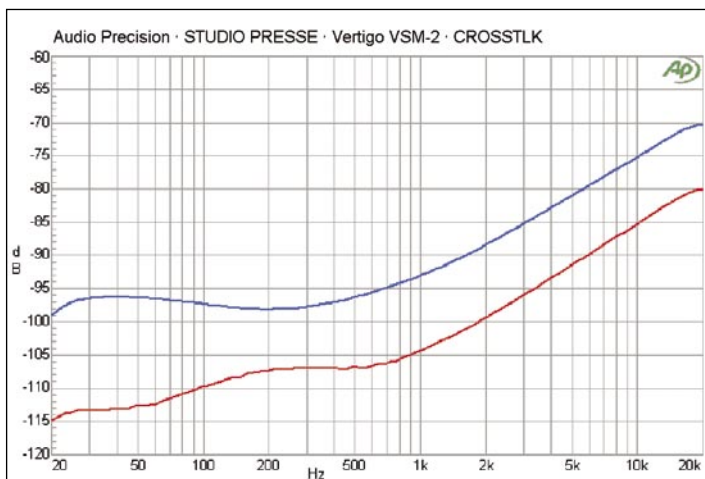
Diagramm 4: Übersprechdämpfung L>R und R>L
